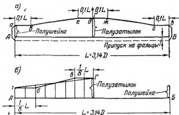
Рис. 141. Способы развертки стакана отвода круглого сечения
