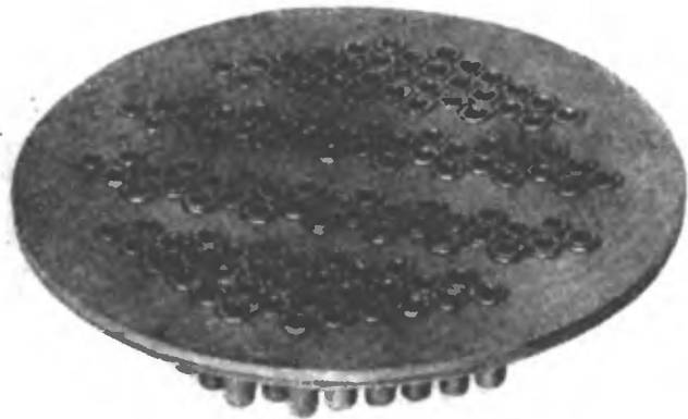
Рис. 125. Опытная трубная решетка с трубками, приваренными проволокой ПП-АН6 с помощью аппарата А-946.
