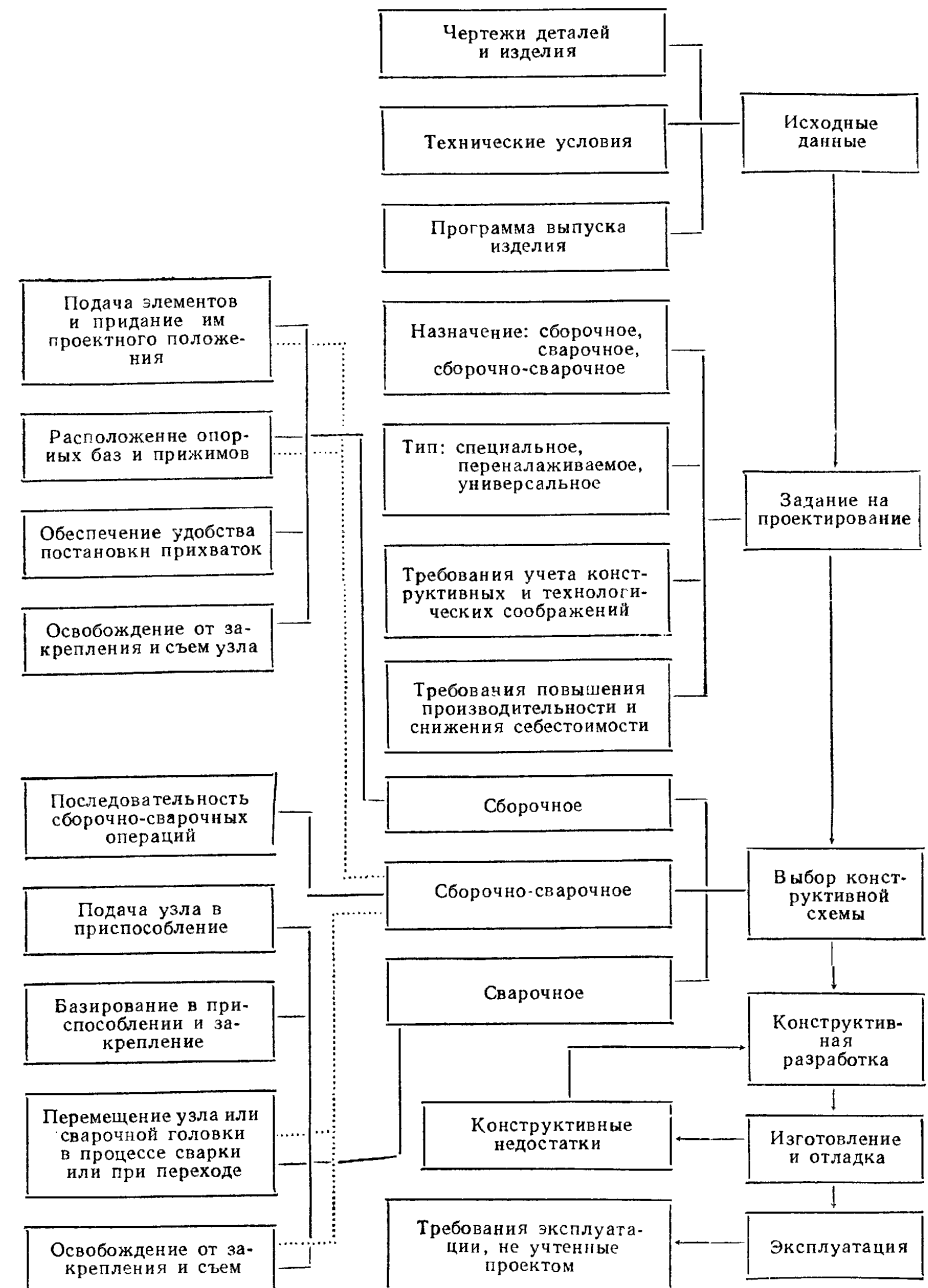
Рис. 5. Схема процесса проектирования сборочно-сварочных приспособлений
