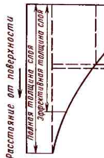
Рис. 6.4. Участок диаграммы состояния Fe-C. Изменение содержания углерода по толщине цементованного слоя. t_{II} — температура цементации при первой загрузке; t_{I} — температура цементации при второй загрузке.
