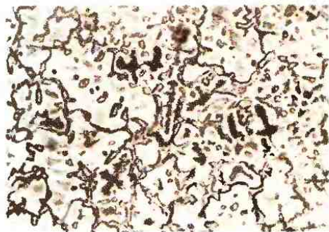
Рис. 12.13. Микроструктура сплава МЛ5 в литом состоянии, \times 340
