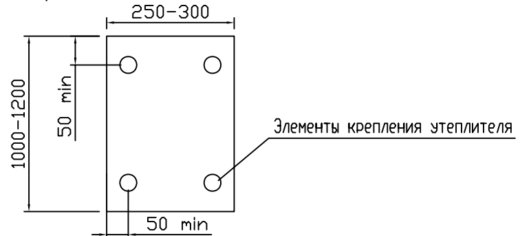
Схема крепления утеплителя на углу здания
