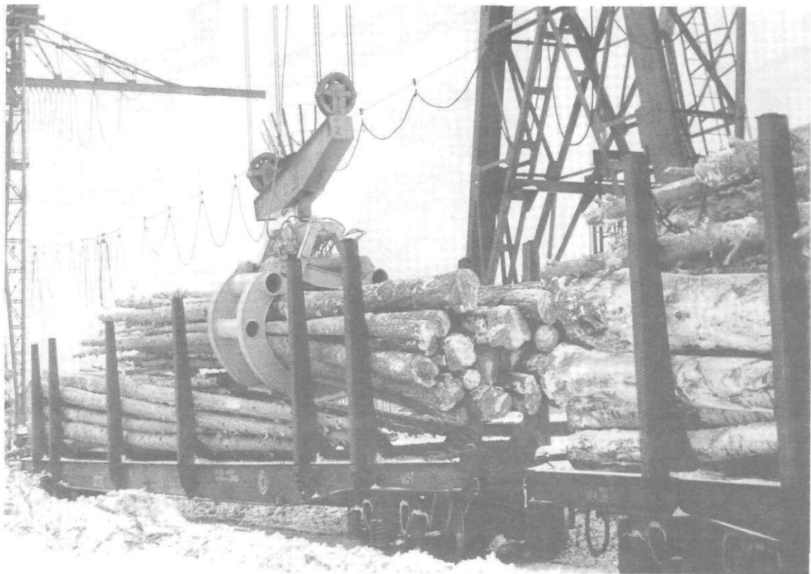
Рис. 3.25. Выгрузка пачки хлыстов из спецплатформы грейфером ЛТ185 (грейфер ЛТ185 прототип изготавливаемого грейфера ГГЛ-400)
