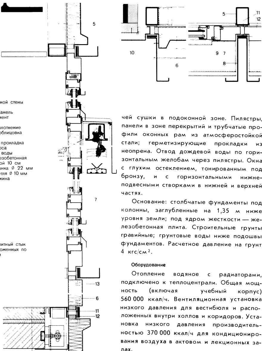
Вертикальный разрез наружной стены
