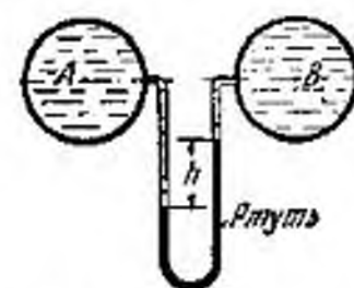
Фиг. 4-4. Схема дифференциального ртутного манометра.
