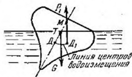
Фиг. 6-7. При крене центр водоизмещения перемещается по линии центров водоизмещения.
