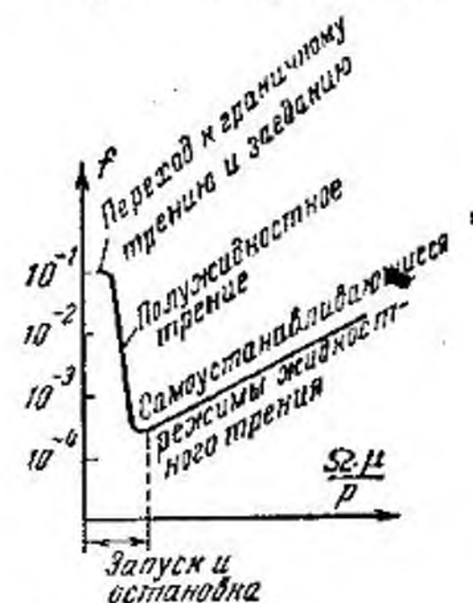
Фиг. 13-6. Зависимость коэффициента трения при различных режимах трения.
