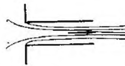
Фиг. 20-12. Схема истечения жидкости через насадок при срыве.
