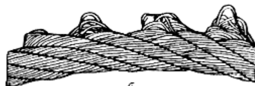
Рис.11. Выдавливание проволок прядей:
